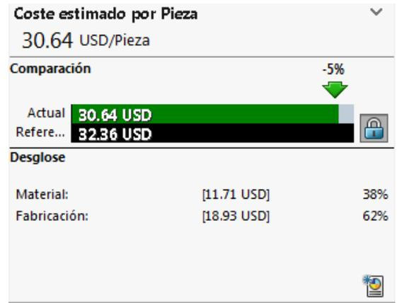
Esta herramienta funciona con una serie de plantillas en las que puedes especificar el material utilizado para crear la pieza, los procesos de fabricación (como *corte con láser*, *flexión* o *fresado*) y los costes asociados de dichos materiales y de las operaciones de fabricación. También permiten crear operaciones personalizadas, como el empaquetado, la entrada en el sistema ERP, la pintura o la limpieza.
