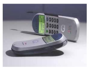
Por medio del software de renderizado de PhotoWorks, puede crear imágenes fotorrealistas a partir de modelos de CAD en 3D. En este caso, utilizamos la iluminación global y materiales realistas de metal, plástico y goma para aumentar el impacto y el realismo del diseño.
