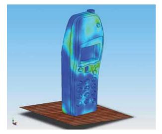
Con SolidWorks Simulation Professional, puede utilizar las funciones de simulación de la prueba de caída para estudiar el efecto del impacto sobre un modelo que se deja caer desde diversas alturas.
